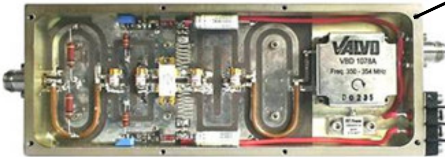
330 W amplifier module - (VDMOS Transistor - Semelab D1029UK05)
